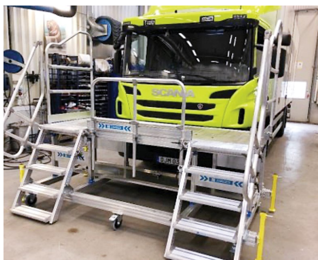
Mobil vedlikeholdsplattform på hjul med to trappeløp hos Skania.
